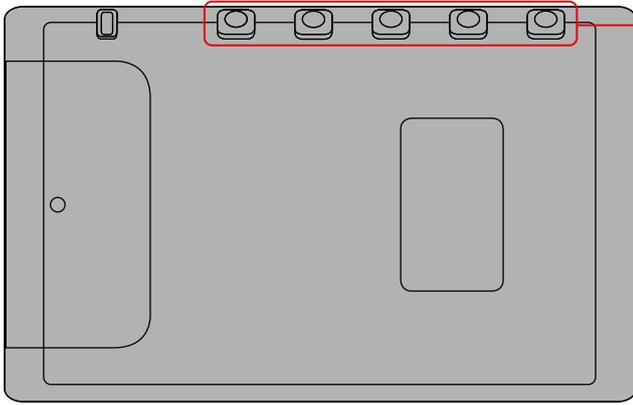
Lichtempfindliche Dioden auf der Rückseite des cardTAN-Generators aktivieren das Gerät um Daten vom Monitor zu empfangen.
